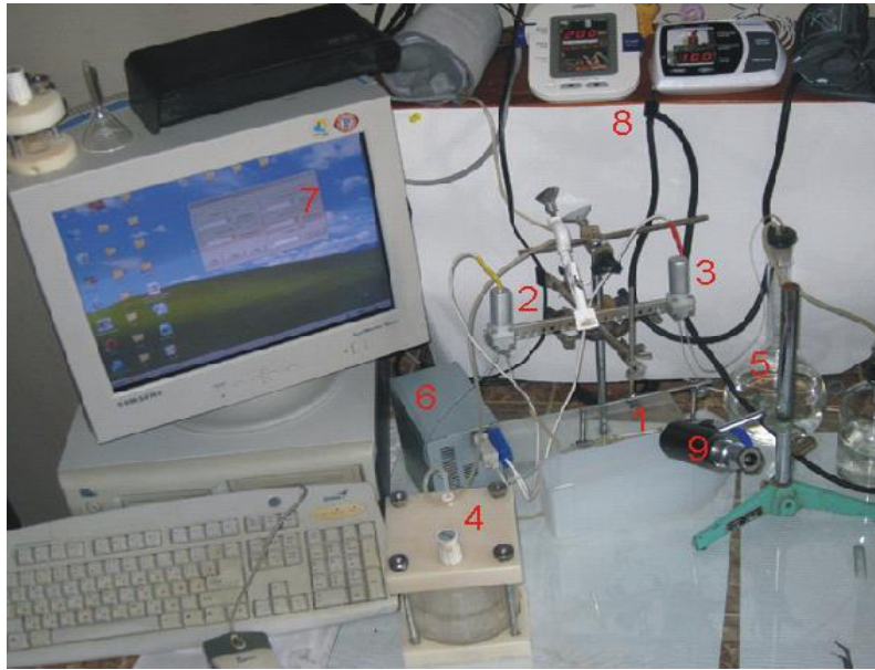
Рисунок 4. Общий вид установки для гидродинамического испытания протезов сосудов.
